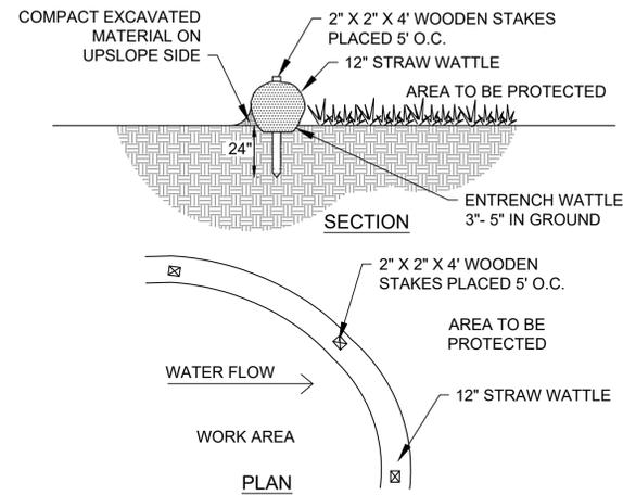
**EROSION CONTROL BARRIER**
